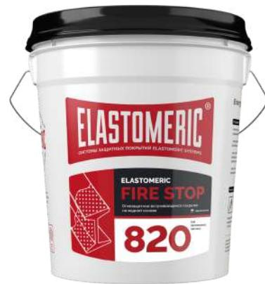
**ELASTOMERIC 820** — однокомпонентное покрытие вспучивающегося типа, огнезащитный состав. При высокой температуре покрытие на основе винила вспучивается в десятки раз, образуя негорючую теплоизолирующую пену, которая обеспечивает огнезащиту металлических, деревянных, железобетонных конструкций. После высыхания образует пленку с ровной однородной матовой поверхностью.
